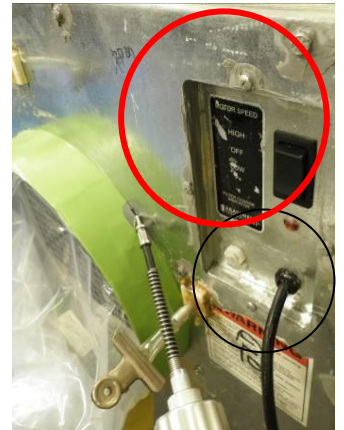
スイッチ等の取り付け部、電源コード取り付け部 ダクト接続口
