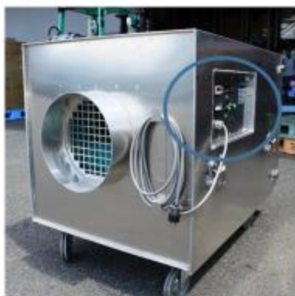
集じん・排気装置 排気側
