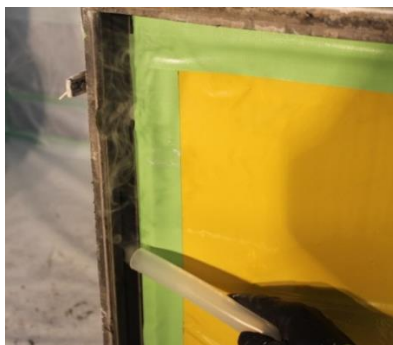
HEPA フィルター周辺部分
